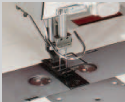
Finestrella di controllo per il riconoscimento ottico della quantità residua di filo spolina Fereastră de observare pentru recunoașterea optică a cantității de ață rămasă în mosorel
